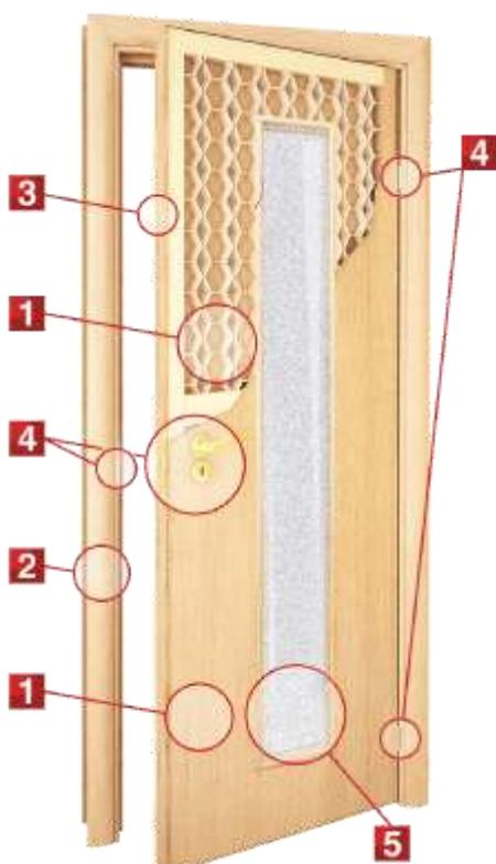
1. Дверное полотно: каркас полотна - МДФ, накладки - ХДФ, наполнение - соты, что способствует звукоизоляции. Сборка выполнена методом горячего прессования.
