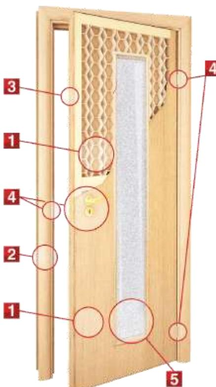
1. Дверное полотно: каркас полотна - МДФ, накладки - ХДФ, наполнение - соты, что способствует звукоизоляции. Сборка выполнена методом горячего прессования.
